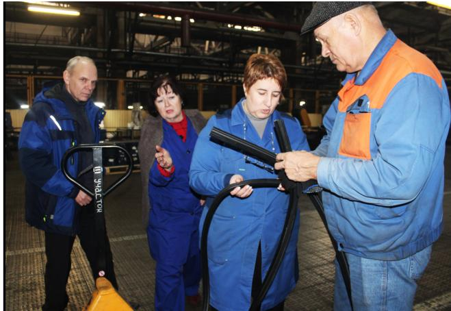
цессе плазменная установка "сжигает" на поверхности резинотехнического профиля тонкую маслянистую плёнку после процесса вулканизации детали. После этой очищающей "процедуры" специальное покрытие идеально ложится на резину.
